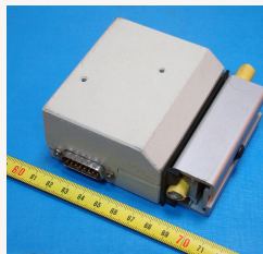
Fig. 9. – Illustration d'une prise vampire. Ces périphériques se branchaient directement sur le câble du bus.
