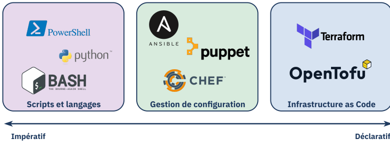
Fig. 94. – Exemple de positionnement des différentes catégories d'outils d'automatisation sur l'axe impératif-déclaratif. Les scripts et langages impératifs sont situés à l'extrémité impérative, tandis que les outils d'IaC sont situés à l'extrémité déclarative. Les outils de gestion de configuration sont hybrides, avec des éléments impératifs et déclaratifs. Les outils SDN ne sont pas représentés sur cet axe, car ils ne sont pas directement liés à la gestion de l'état des systèmes, mais plutôt à la gestion et au contrôle des réseaux.
